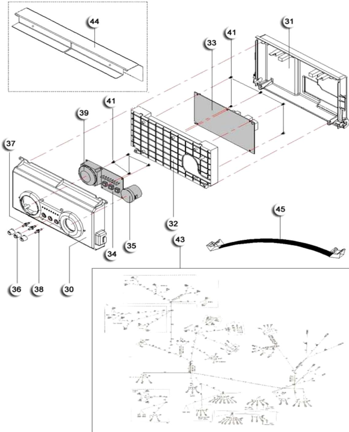
**Панель управления****Solaris****ВК (НК) - 117, 124, 130 - В(S) - S**
